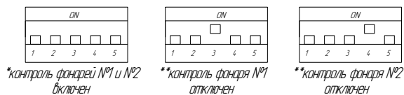
Варианты выставление DIP перкл. на силовом блоке BS KM контроль питания:
